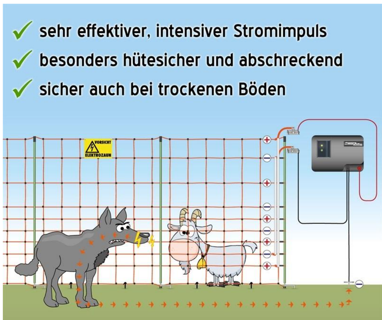
Funktion eines modernen +/- Netzes (Quelle: Voss-Farming)
